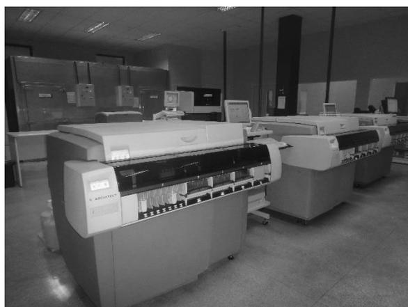
A unidade Central Sabará possui três equipamentos I2000, sendo dois deles acoplados ao equipamento C8000 (Bioquímica) e um stand alone.
